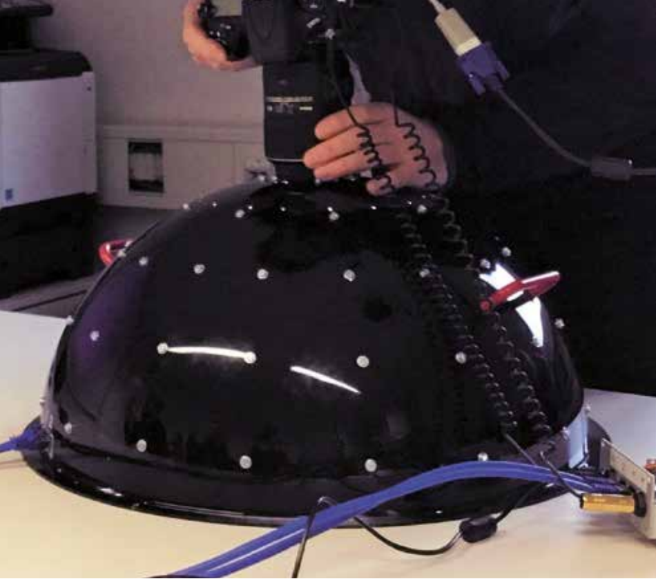
Der »Kölner Dome«, eine Konstruktion des Cologne Center for eHumanities. Der Apparat erlaubt es, Siegel und andere Objekte aus verschiedenen Winkeln anzuleuchten und zu fotografieren. So werden besonders schwer lesbare Inschriften wieder sichtbar
