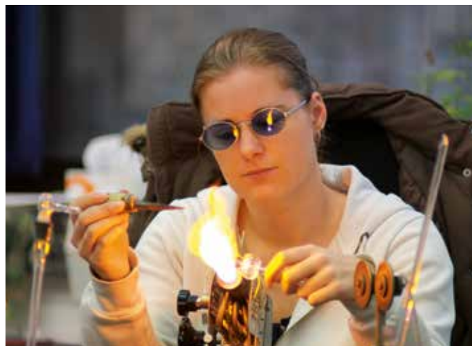
▲ NADINE ODDO VERARBEITET einen Glashahn an der Glasbläserlampe.
