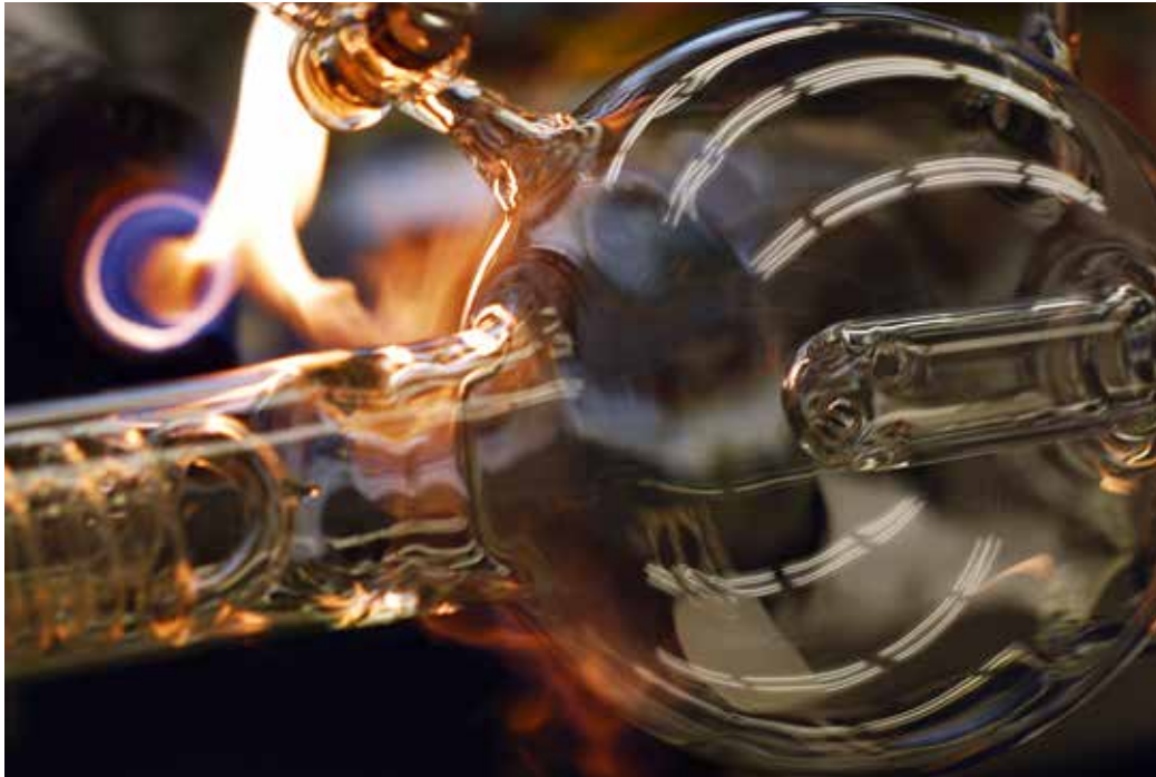
▲ HERSTELLUNG EINER KOLONNE an der Glasdrehbank
