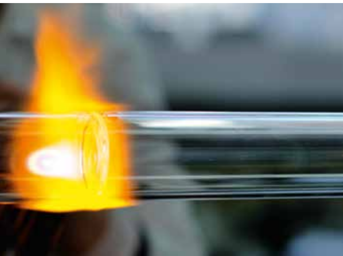
◀ VERARBEITUNG EINES GLASROHRES an der Glasdrehbank.
